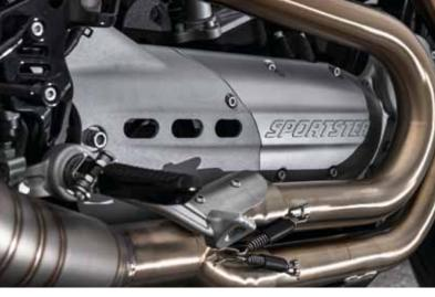
Die selbst gefräste obere Gabelbrücke nimmt nicht nur das integrierte motogadget-Instrument auf, sondern dient auch als Halter für die Lenkerstummel. Von der Schwinge stammt die Idee für die Langlöcher im Abtriebsdeckel
